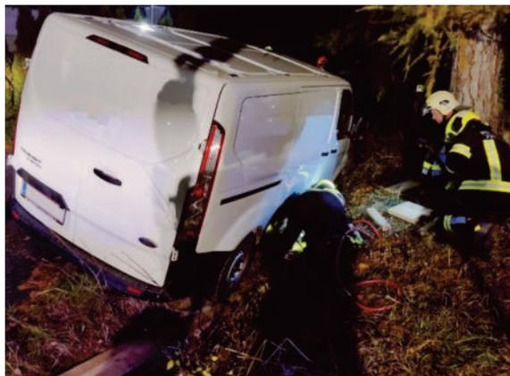
Damit das Fahrzeug bei der Bergung nicht beschädigt wird, wurde das Fahrzeug mittels Hebekissen gehoben und mit Pfosten unter den Reifen eine Rampe gebaut. Danach wurde der Lieferwagen schonend aus dem Graben gezogen. Nach der Bergung konnte der Fahrer die Fahrt fortsetzen.
